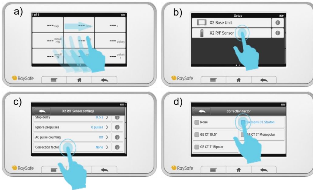
Hình 3: Cài đặt hệ số hiệu chỉnh trong máy chính X2 để đo kVp trên máy quét CT của Siemens với ống tia X STRATON.
